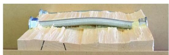
Knickversagen eines Prüfkörpers
