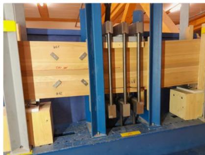
Schubprüfung mit mittig angeordneter Blockfuge
