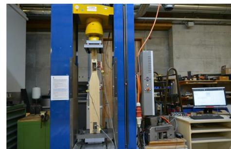
Abbildung 3: Zyklischer Versuch Tests an Gruppen von zwei GS-Ankern an der BFH AHB in Biel
