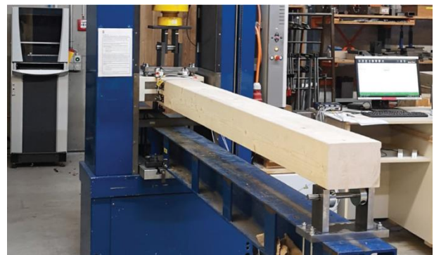
Biegeprüfung im Zuge der fünften Prüfserie an der BFH in Biel
